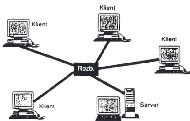
každé stanici samostatný kabel. Výhodou je obrovská stabilita. Chybou sítě, jako přerušený kabel apod., se vztahují pouze na jednu větev - její nefunkčnost nemůže ohrozit zbývající články sítě. Se sítí lze za běhu manipulovat - odebírat a přidávat do rozbočovače části sítě. Mezi hlavní nevýhody topologie hvězda se řadí hlavně pořizovací cena. Na rozdíl od topologie sběrnice jsou zde použity další prvky (např. rozbočovače) a je podstatně vyšší spotřeba kabelů.
